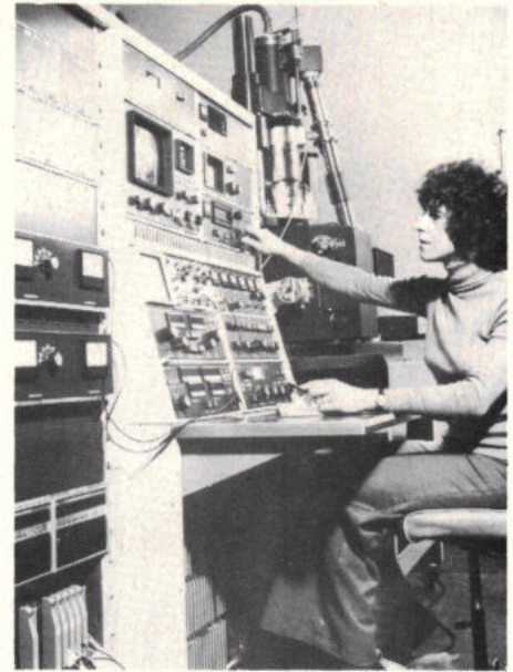
Afb. 2. Beproeving van de in Redhill gebouwde apparatuur voor het maken van geïntegreerde schakelingen met behulp van een elektronenbundel.
